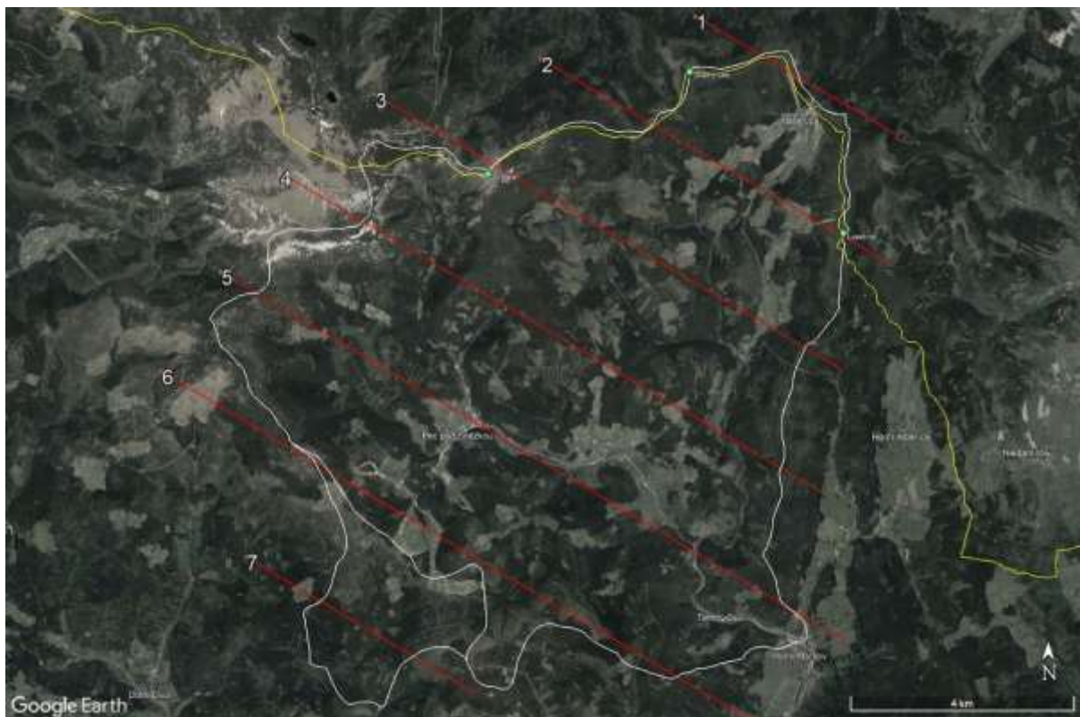
Obrázek 1 Plán letové kampaně nad zájmovým územím povodí Horní Úpy a říčky Čistá (bílé polygony) v národním parku Krkonoše. Středů jednotlivých linií 1 - 7 (červené linie) jsou naplánovány pro azimut slunce 120°.
